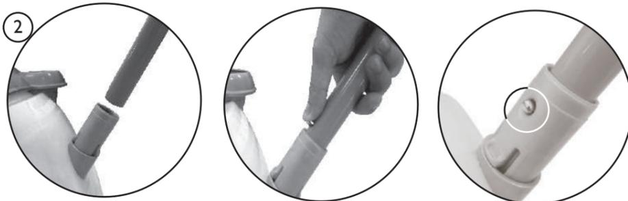
Encaixe a haste na bucha superior da trava da haste, que está localizada no corpo, conforme imagem. Para fixar, pressione o pino mola até que ele passe pela bucha superior da trava da haste e fique encaixado no furo correspondente. Para retirar faça a operação inversa.
