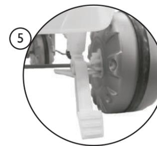
Para acionar o freio, pressione o pedal do freio para baixo para frear o triciclo. Para colocar o triciclo em movimento, faça a operação inversa. **(Freio somente para referência 2173 e 2334).**
