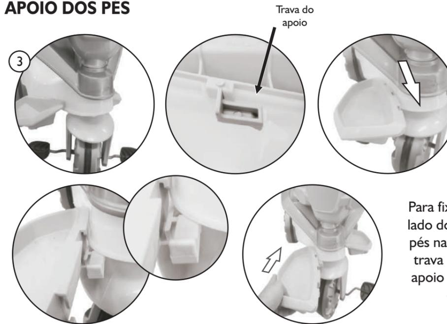
Para retirar o apoio dos pés, vire o guidão para o lado do apoio a ser retirado, pressione a trava localizada na parte de baixo do apoio dos pés e desloque o apoio dos pés para frente até que seja completamente removido.
