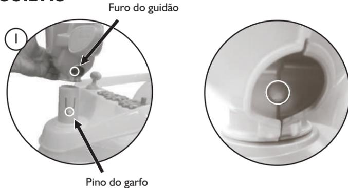
Insira o guidão na extremidade superior do garfo e pressione até o total encaixe. Certifique-se de que o pino do garfo esteja encaixado no furo do guidão. Para remover pressione o pino do garfo e remova o guidão.
